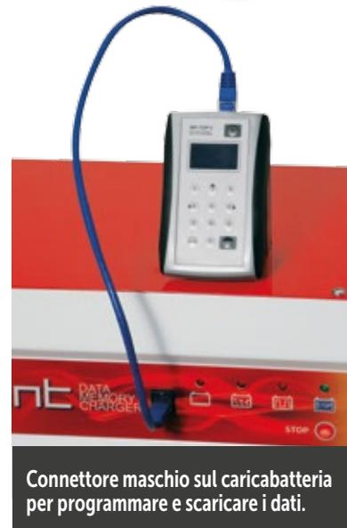
Connettore maschio sul caricabatteria per programmare e scaricare i dati.
