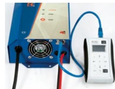
Connettore maschio sul caricabatteria per programmare e scaricare i dati.
