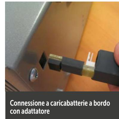
Connessione a caricabatteria a bordo con adattatore
