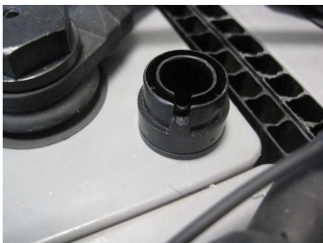
Infilare il bulbo nel cilindro. Spingerlo fino in battuta sull'elemento interno della batteria:
