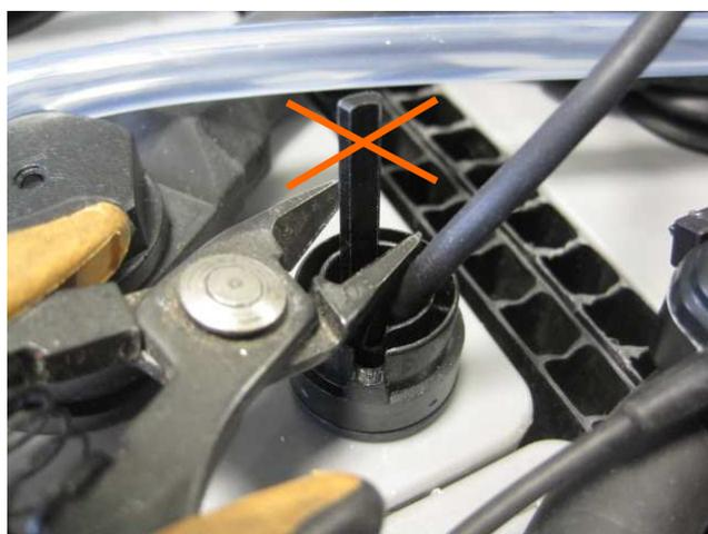
Sagomare il cavo piegandolo e imboccandolo nell'apposita cava di passaggio. Chiudere il cilindro con l'apposito tappo fornito in dotazione:
