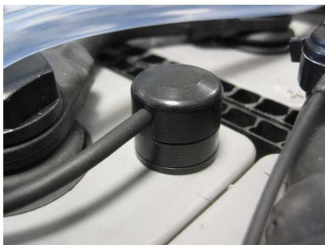
L'installazione dello **SPY-BATT** sulla batteria è completata.
